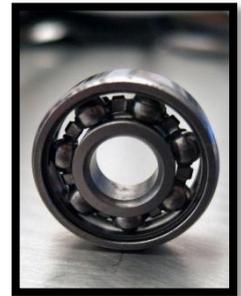
Figure 49 Exemple d'un roulement
