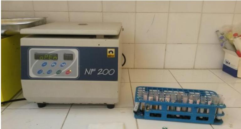
Image original 2018 ; centrifugeuse horizontale de type nüve
