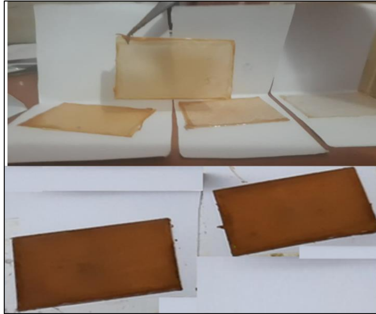
Figure 2.4. Photographie des films minces via la technique de spin-coating (5 couches) avec diverses quantités de goethite ou HFO.
