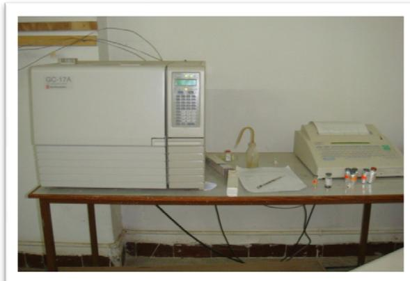
**CPG SHIMADZU de type GC-17A**
