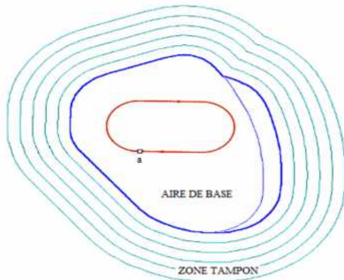
Fig. III.19.4 : Attente point fixe basée sur un VOR-DME en rapprochement
