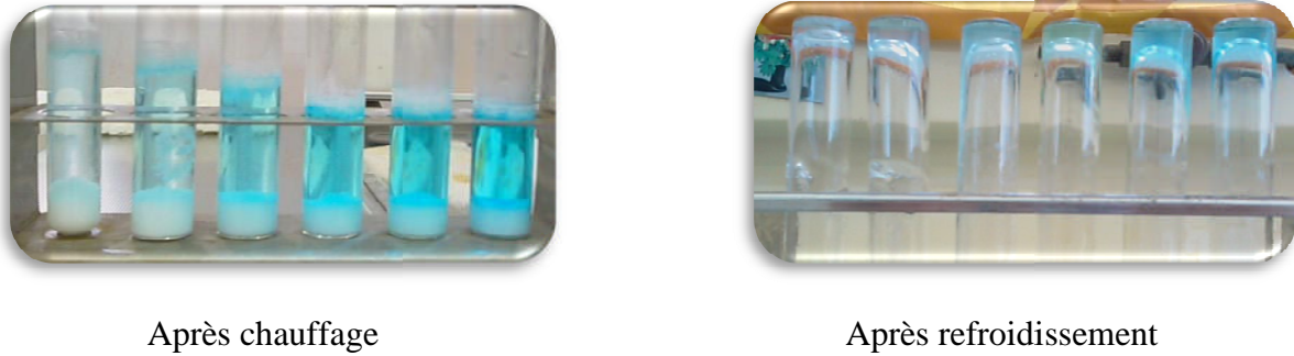
Figure 1.12 : Aspect macroscopique des solutions de HPC (15g/L) (De gauche à droite 0,5-5% \text{CuSO}_4 )
