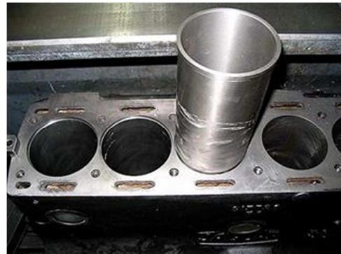
Fig.6: Bloc cylindres avec chemise rapporté (avec emmanchement)
