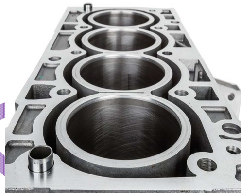
Fig.7 : Bloc cylindre en aluminium avec chemise rapporté (à la coulée)
