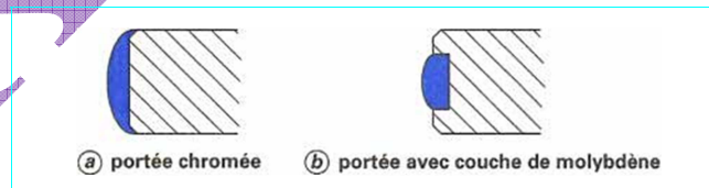
Fig.36 : revêtement des segments
