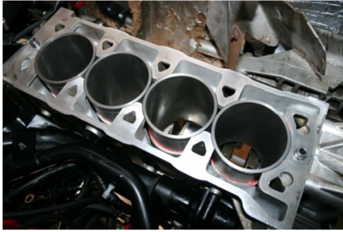
Fig.8: Bloc cylindres avec chemises amovibles
