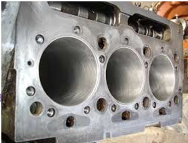
Fig.4 : Cylindre en aluminium avec chemise intégrées
