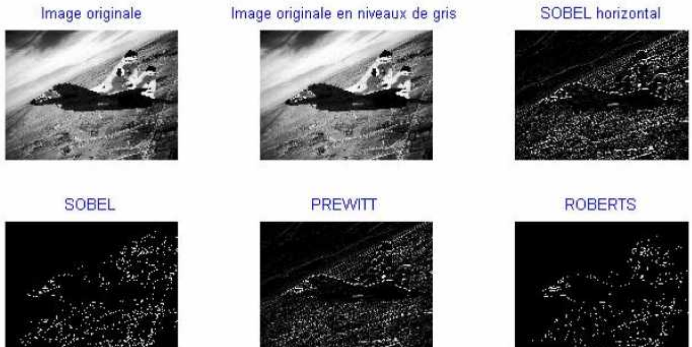
Figure III-12 : Détection de contour par les filtres Gradient
