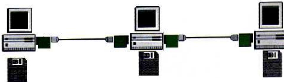
Figure 4.1 : L'architecture d'un réseau linéaire.
