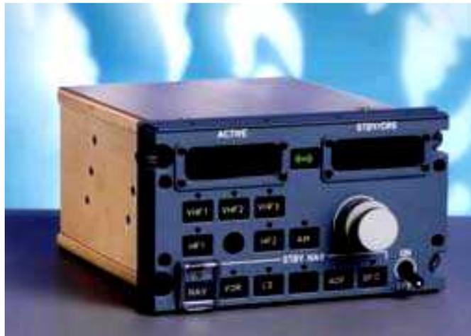
Figure 3.12: La boîte de commande radio (RMP).
