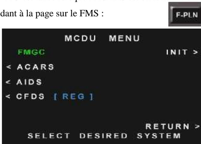
Figure 3.5: La sélection de l'ACARS sur le MENU MCDU.
