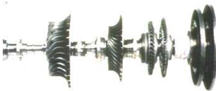
Figure (II.11) : L'ensemble compresseur –turbine (rotor)
