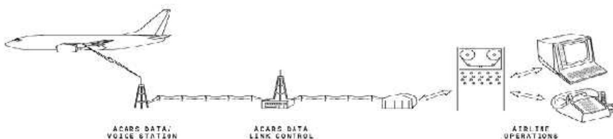
**Figure I-12 : Le principe de l'ACARS**
