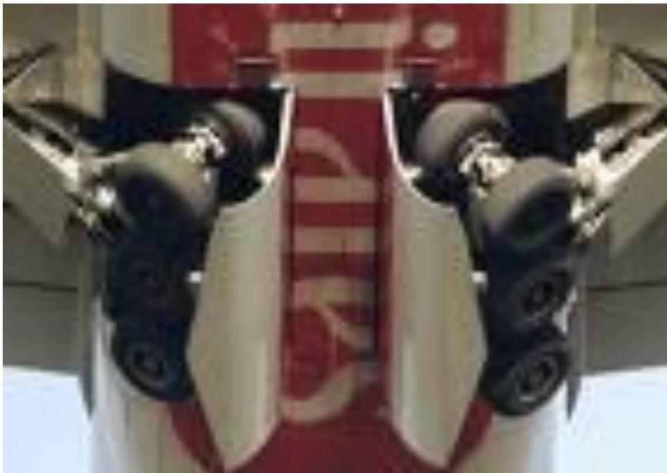
Figure. 25: Rentré des atterrisseur et fermeture des trappes.
