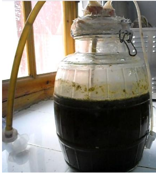
Figure II.16 : Changement du substrat au cour de la digestion anaérobie.
