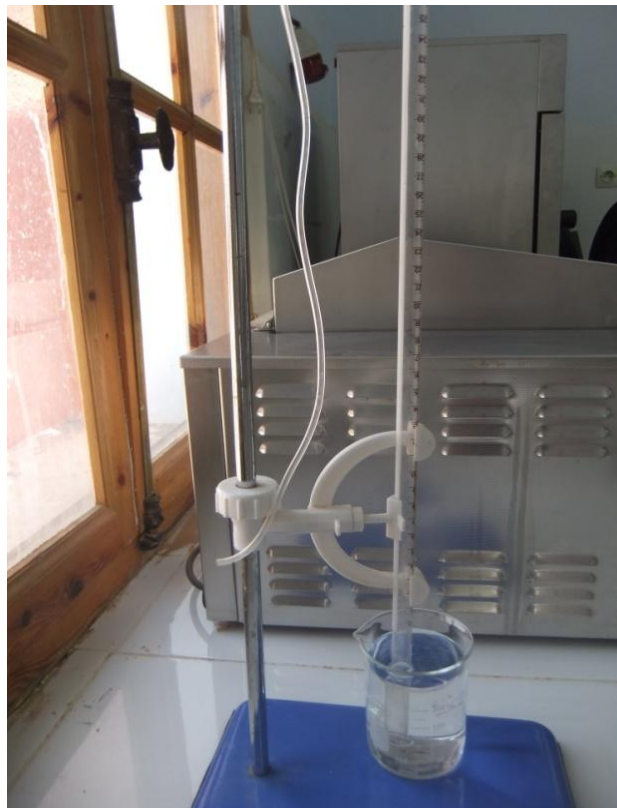
Figure II.10 : Dispositif de mesure du volume du biogaz produit.
