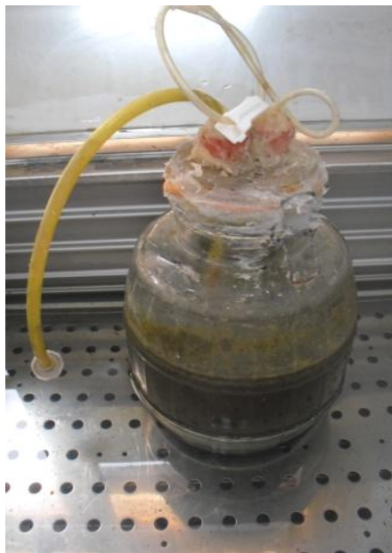
Figure II.5 : Photo des réacteurs dans un bain marie chauffé et régulé à 37°C.
