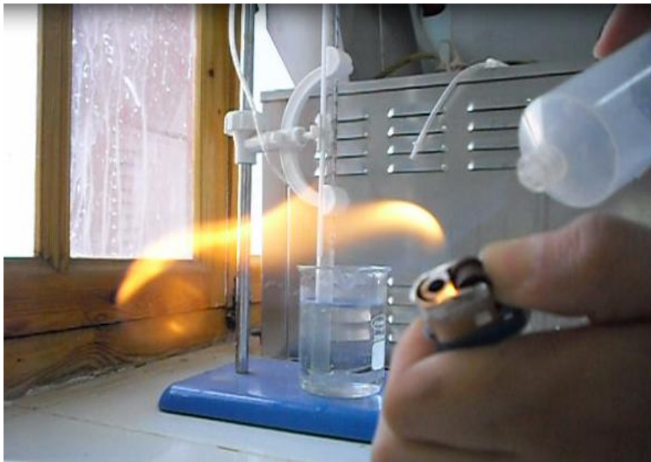
Figure II.20 : Teste d'inflammabilité du biogaz produit.
