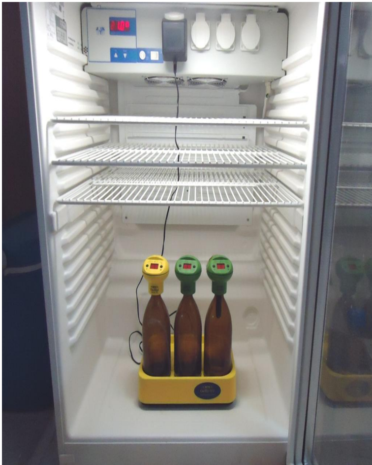
Figure II.13 : Système utilisé pour la mesure de la DBO_5 .
