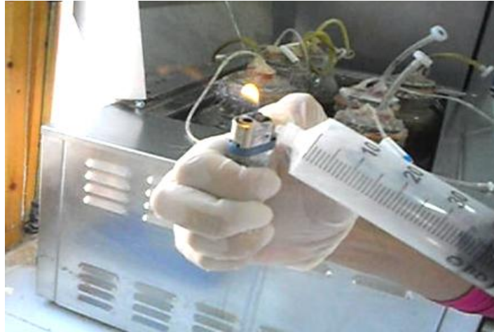
Figure II.14 : Teste d'inflammabilité du biogaz produit.
