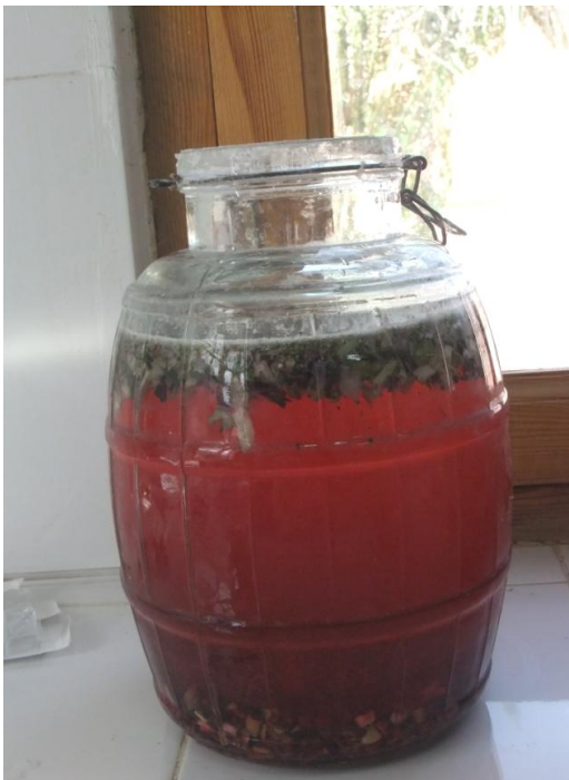
Figure II.4 : Photo de digesteur rempli avec le substrat et l'eau.
