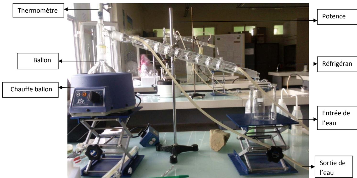
Figure III.1 : Schéma de Distillation de l'huile essentielle brute
