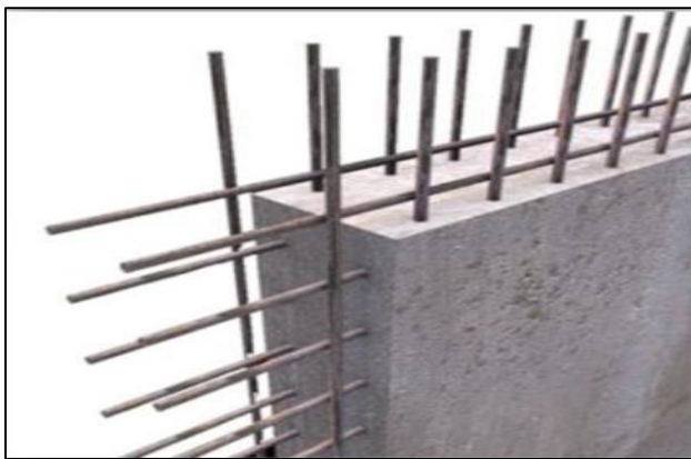
Figure 07: Voile en béton armé.
