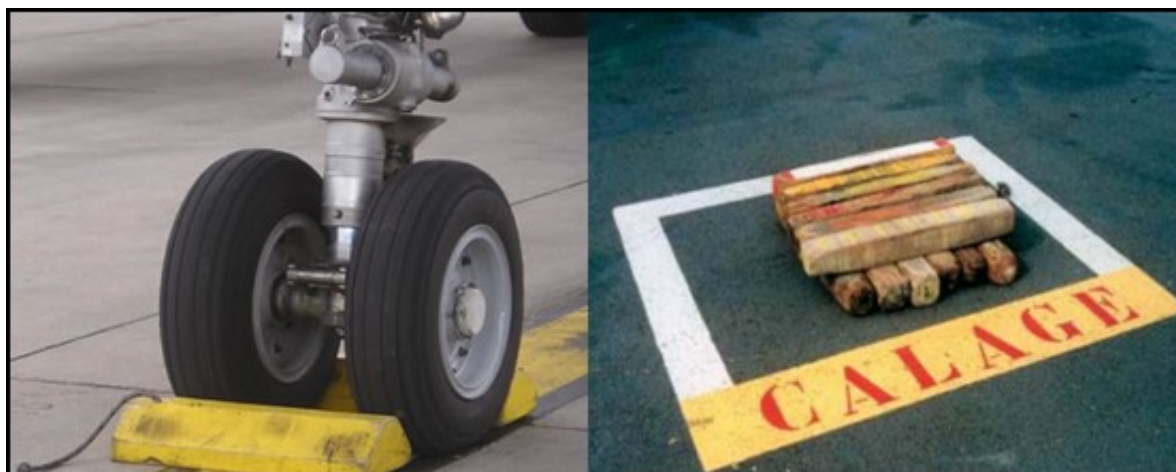
Figure 4.17: Utilisation des cales (métallique et en bois)
