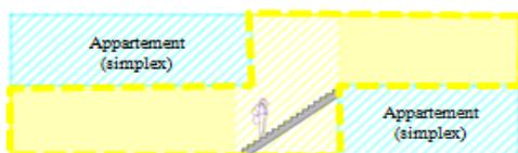
Figure II.5 : coupe schématique du duplex
