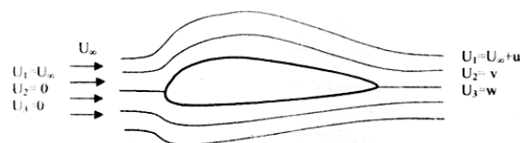
Figure A.8 Perturbation de l'écoulement par la présence du profil
