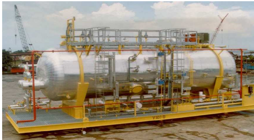
Figure II.7 : Vue extérieure d'un dessaleur électrostatique sur skid sortie usine
