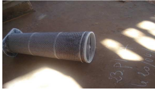
Figure I.3: Bouchage de la pompe de rebouillage.
