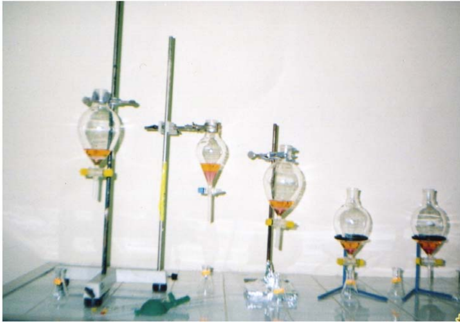
Figure 4-3: Technique de la méthode de dithizone
