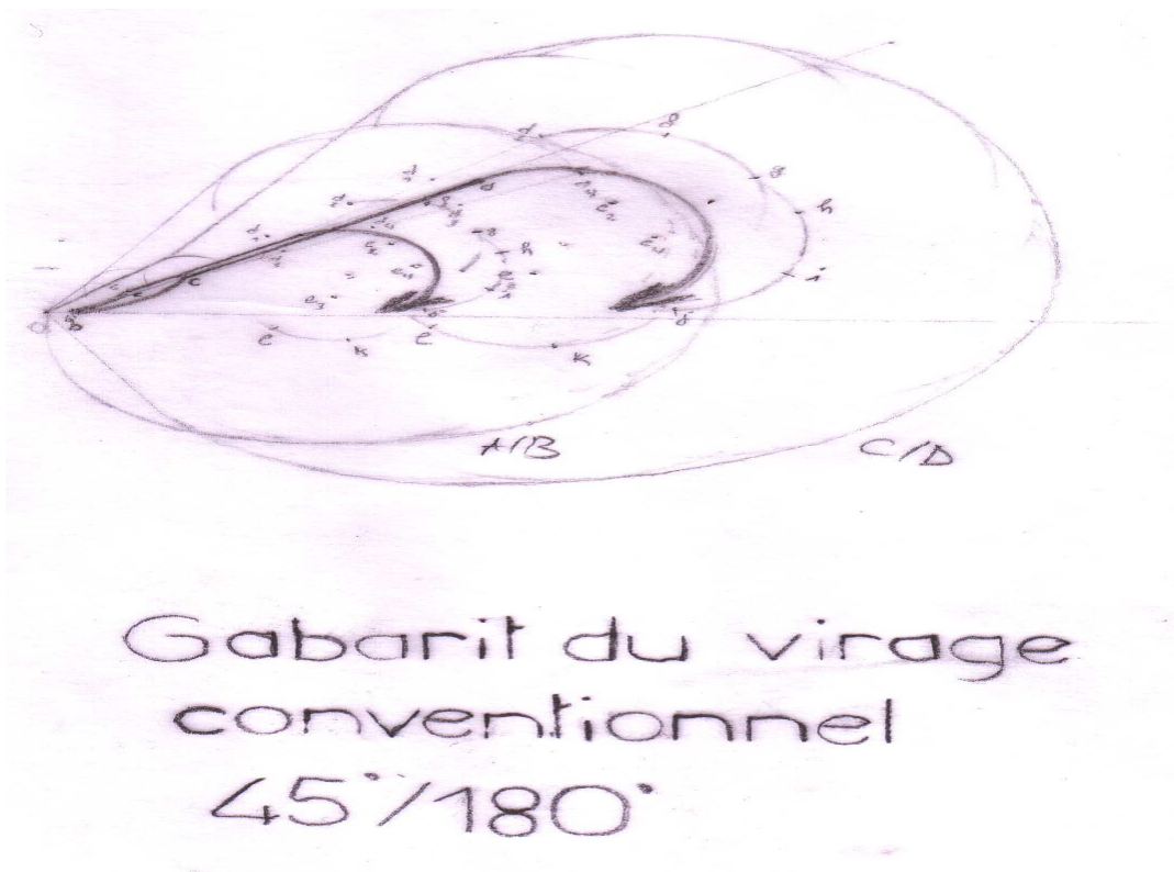
Figure VI.2 : gabarit du virage conventionnel (voir ANNEXE B)
