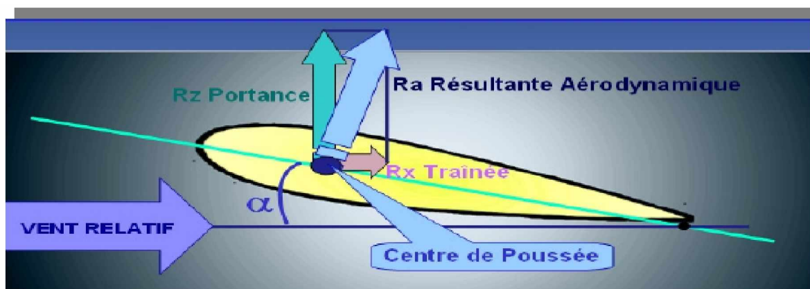
Fig. II.11. Schémas représente La résultante aérodynamique sur un profil d'aile
