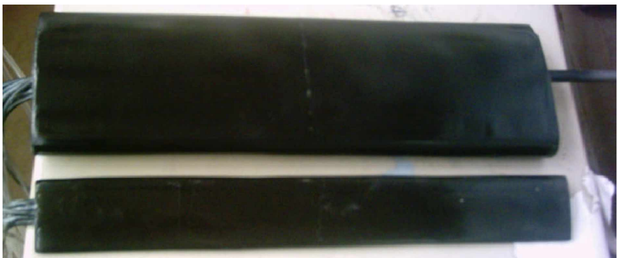
Figure II.30. Vue générale du profil avec le volet.
