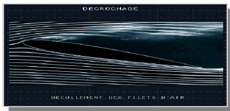
Fig. II.13. Décrochage d'un profil de l'aile
