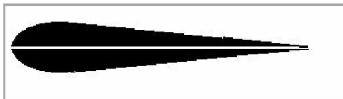
Fig. II.3. Profil biconvexe symétrique
