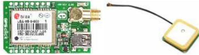
Figure.IV.2. Module GPS Click Board avec son antenne patch.
