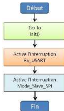
Figure.III.15. Organigramme du PIC esclave de la carte « C02B » du sol.
