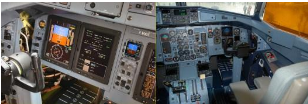
Figure IV.2. La Bande médiane : ATR72-600 cockpit (à gauche) et l'ATR72 -500 cockpit (à droite).
