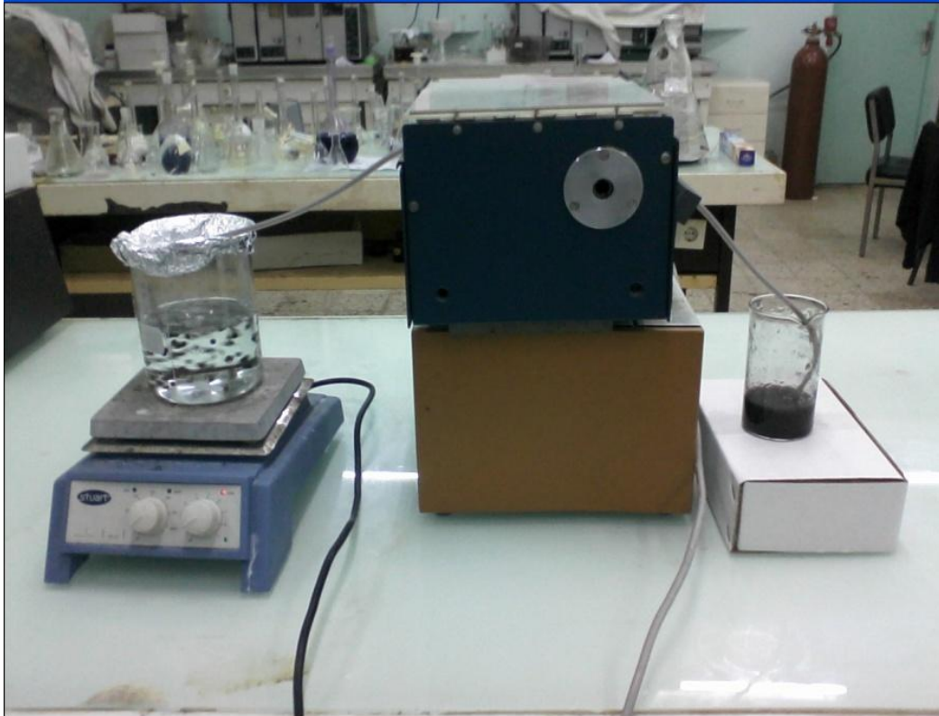
Figure.II.1: Schéma du dispositif expérimental illustrant la préparation des billes d'alginate gélifiées.
