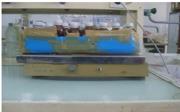
Figure IV.1 Photo montrant l'appareil d'agitation à oscillations utilisé.
