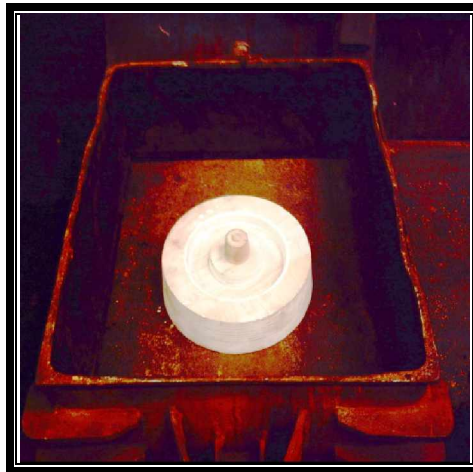
Fig. IV.7 : Le moule a l'intérieur de demi-châssis inferieure.
