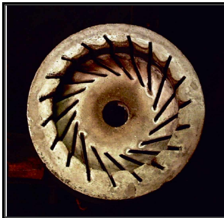
Fig. VI.6 : noyau après l'enduirage et séchage.
