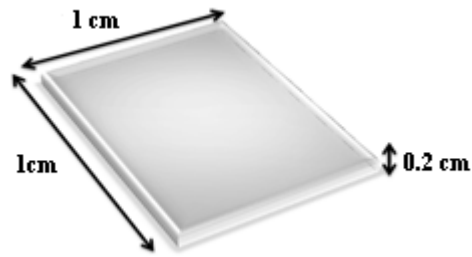
Figure 3.1. Schéma de l'éprouvette utilisée
