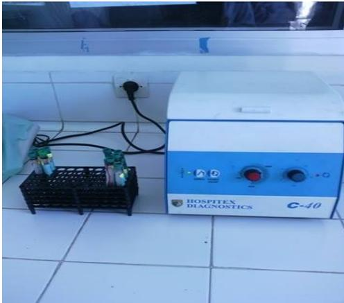
**Centrifugeuse de type Hospitex Diagnostics C-40.**
