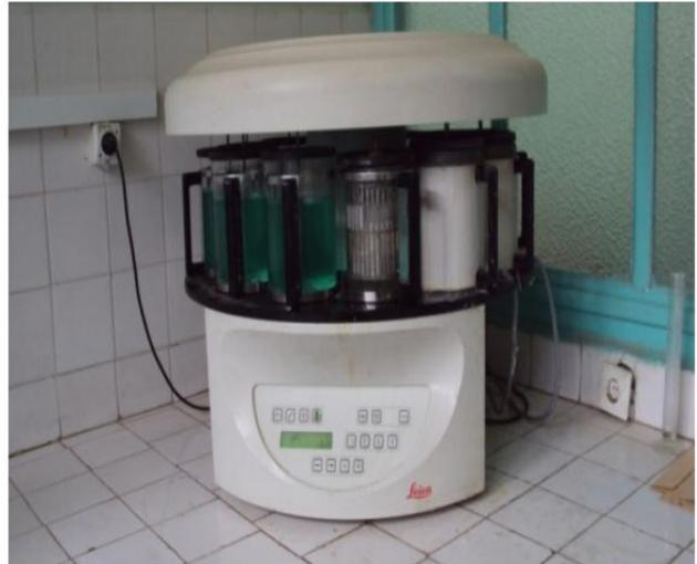
**Appareil à circulation automatique (Leica).**
