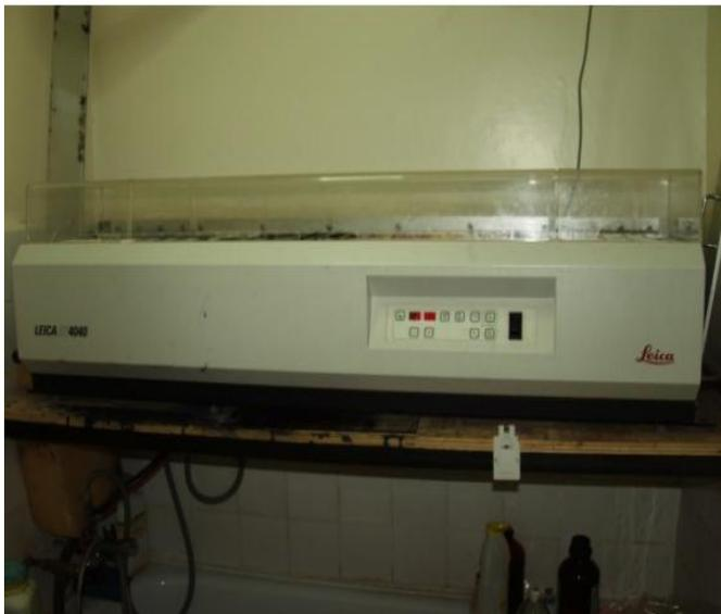
**Appareil à coloration automatique (Leica ST 4040).**
