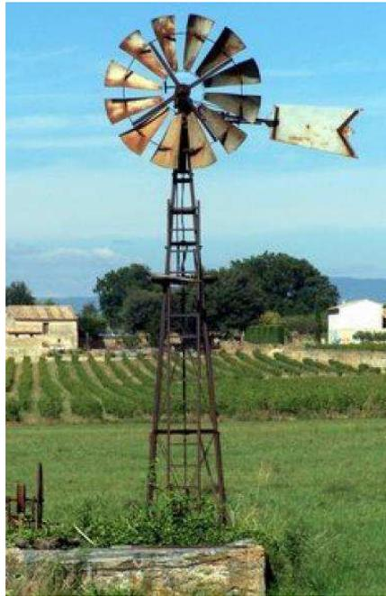
Fig.1.3 : éolienne de pompage.
