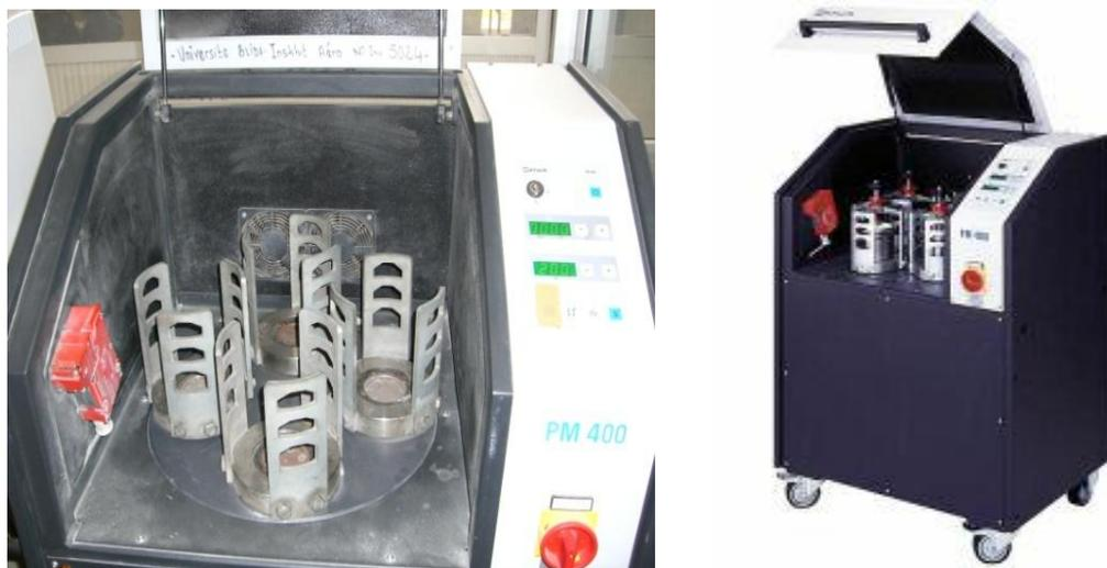
**Figure II.1.a** : Broyeur planétaire, de marque commerciale RETSCH PM 400, utilisé pour la mécanosynthèse des alliages Al-Ti.
