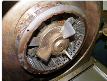
**Figure I.6 :** Broyeurs à marteaux.
