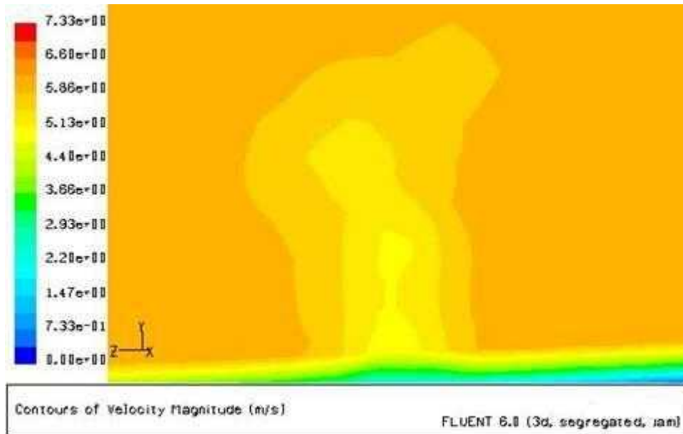
Figure 63 : Le contour de la vitesse autour du plan 3(cas2, v=6\text{m/s} )
