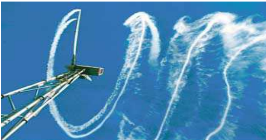
Figure 7 : le sillage créé par une éolienne [2]
