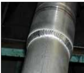
Fig.I.15. Images montrant la qualité de soudure par le procédé TIG
