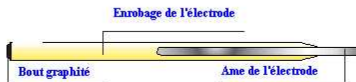
Fig. I.14-schéma d'une électrode enrobée
