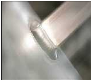
Fig.I.15. Images montrant la qualité de soudure par le procédé TIG
