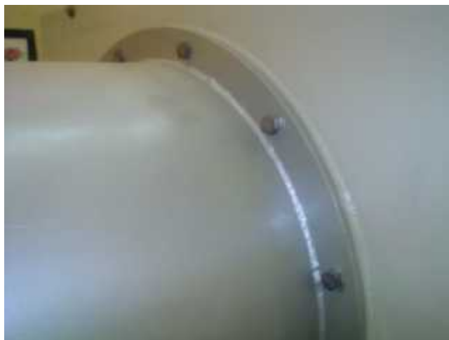
Fig.I.13- Tuyère d'une soufflerie subsonique
