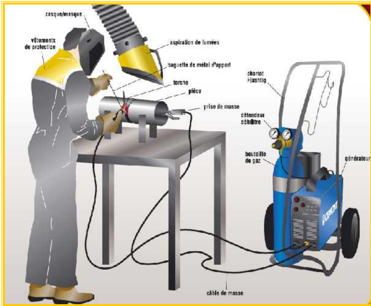
Fig.I.7 : Schéma type d'une installation manuelle du soudage TIG
