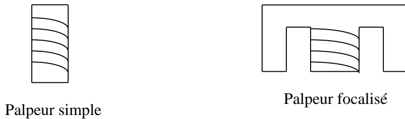
Figure III-23 : Différents types de palpeurs
