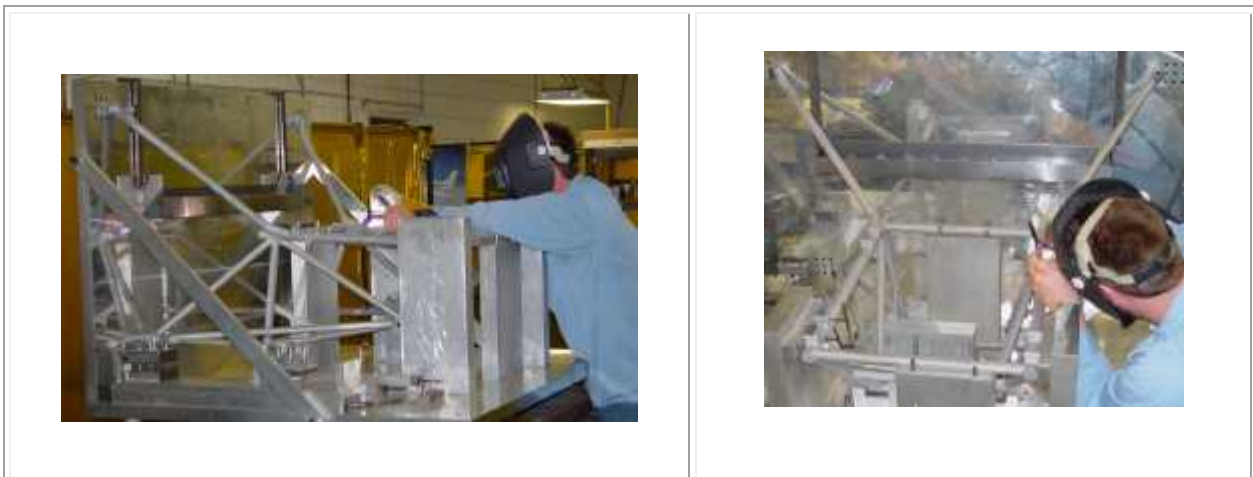
figV-4 : L'opération de soudage des bâtis sur des gabarie
