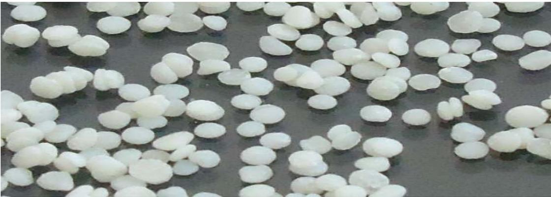
**Figure 17.** Photo macroscopique des microcapsules à base d'alginate de sodium et copolymère 1
