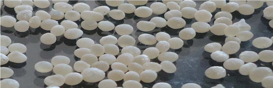
**Figure 16.** Photo macroscopique des microcapsules à base d'alginate de sodium seul
