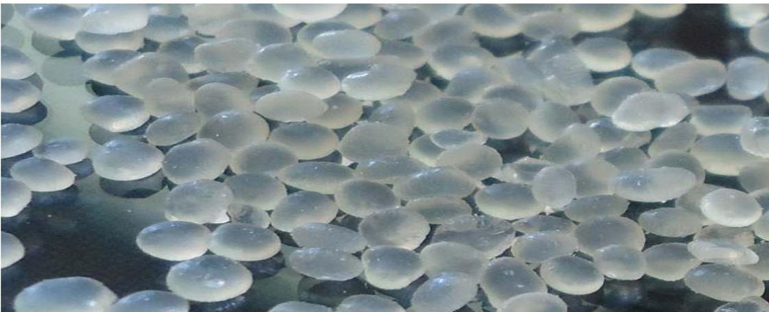
**Figure 18.** Photo macroscopique des microcapsules à base d'alginate de sodium et copolymère 2
