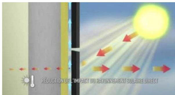
Figure 131 : Détail protection du rayonnement solaire/source : Les principes de la façade ventilée, par Eternit - YouTube
