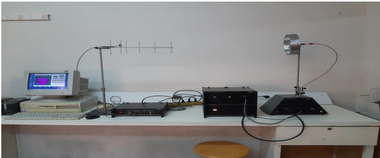
Figure (III.34): Photographie du montage de mesure du diagramme de rayonnement.
