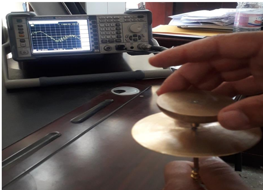
Figure (III.11): Photographie de mesure de l'antenne réalisée.
