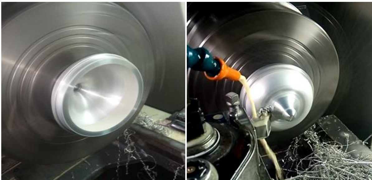
Figure (III.30): Photographie de conception de l'antenne vidée.
