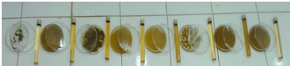
**Figure VII.12.** Après la filtration, les microparticules (filtrats) sont dans les boites à pétrie et les substances filtrées sont dans les tubes à essaies.
