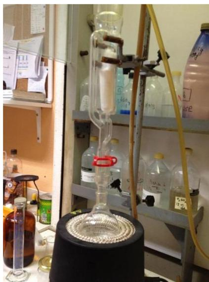
Figure VI.3. Un dispositif de Soxhlet
