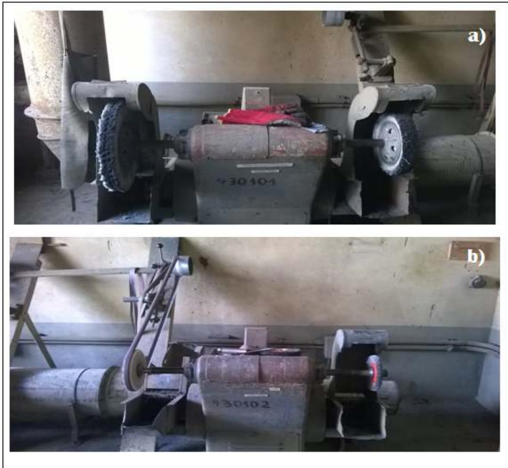
Brosses électriques, b) : Polissages mécanique
