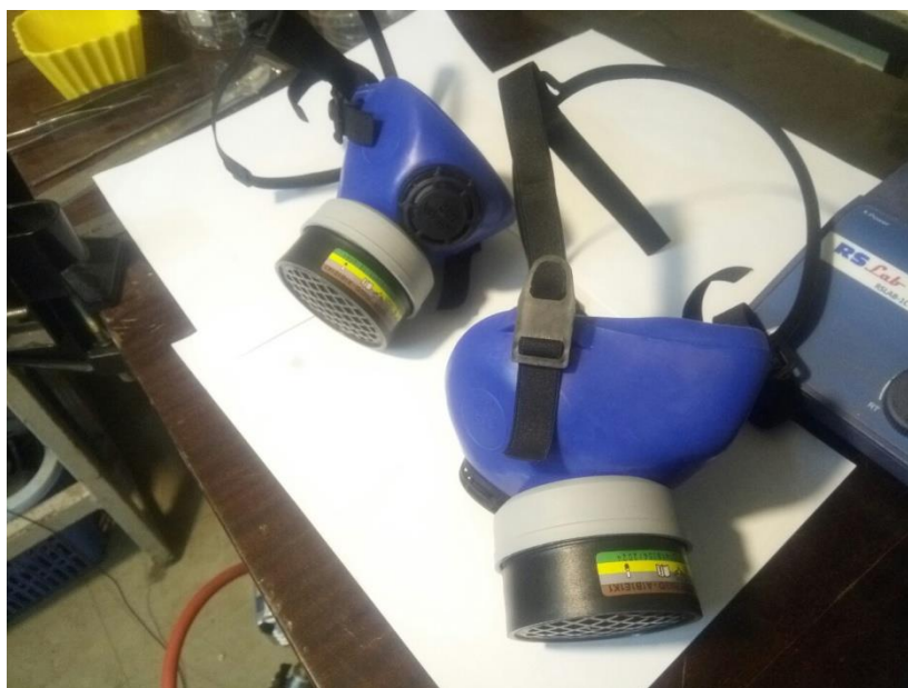
Figure 32: Masque de protection équipé de cartouche à charbon actif pour solvant organique.
