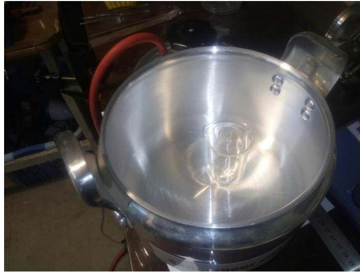
Figure 30: Aspiration des bulles d'air dans une cloche sous vide.
