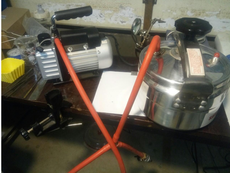
Figure 27: Séchage des blocs métalliques sous vides dans une cloche sous vide.
