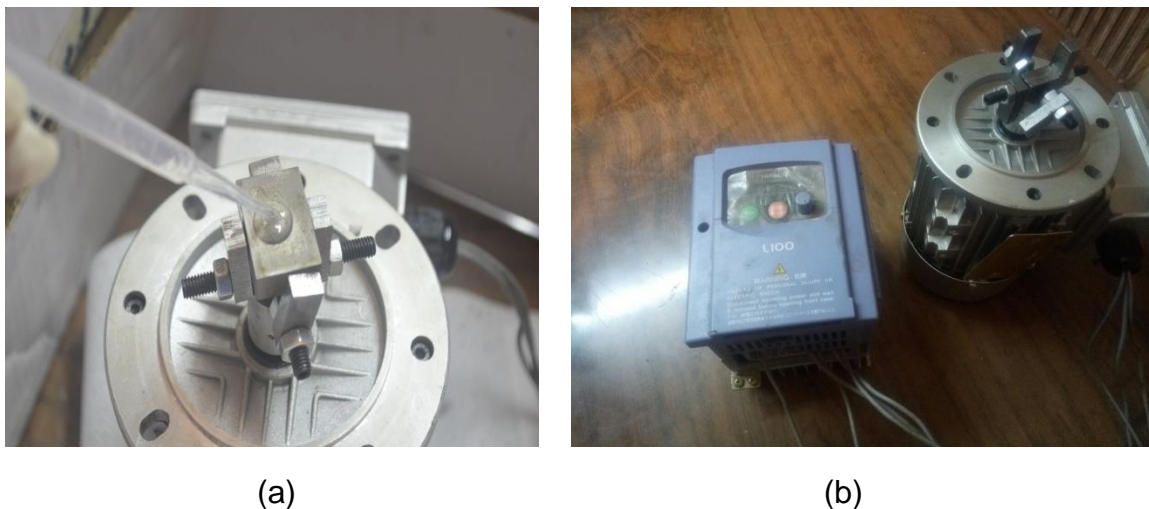
Figure 33: a- Dispositif de fixation des blocs métalliques sur la tournette d'étalement du film de PDMS. b- Appareil de commande et de variation de la vitesse de rotation de la tournette.
