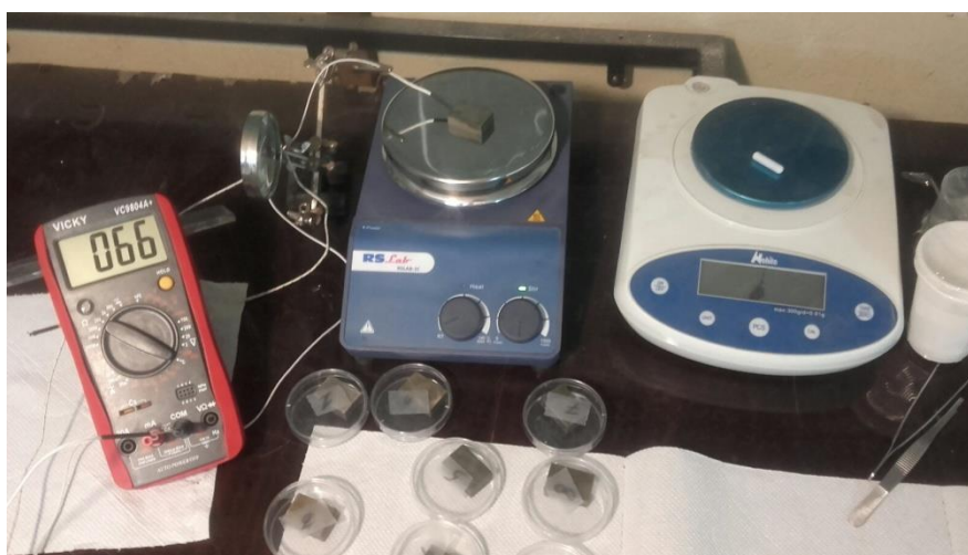
Figure 39: Mesure de la cinétique de chauffage propre d'un bloc métallique.
