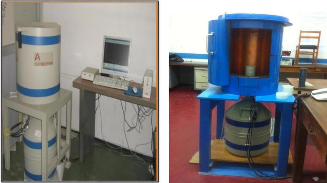
***Figure III-4:*** Chaîne de spectrométrie gamma
