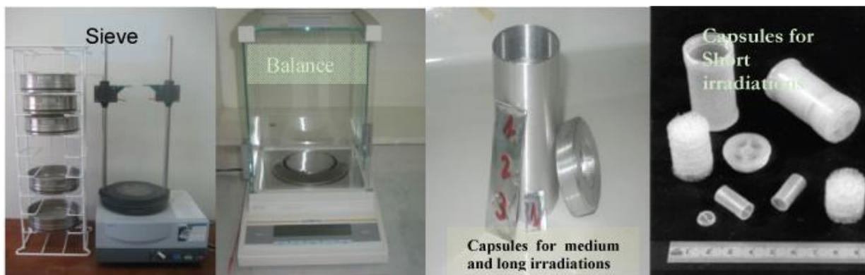
**Figure III-2:** Instruments et matériels utilisés pour l'irradiation des échantillons.
