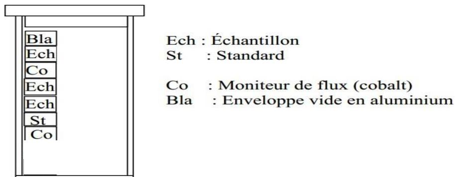
**Figure III-3:**Conditionnement des échantillons dans la capsule d'irradiation
