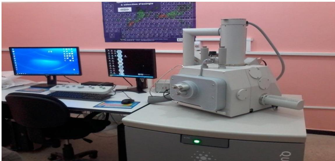
**Figure IV.4.** Microscopie électronique à balayage QUANTA 650
