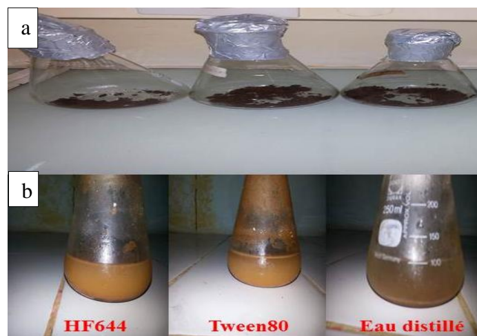
Figure 3.7 : Photos montrant l'aspect des hydrocarbures pétroliers mobilisés du sol. (a) avant traitement, (b) après traitement.
