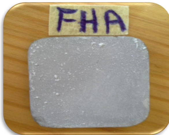
Figure 2.13- Aspect visuel de dépôt de fluorohydroxyapatite FHA sur l'acier inoxydable 316L
