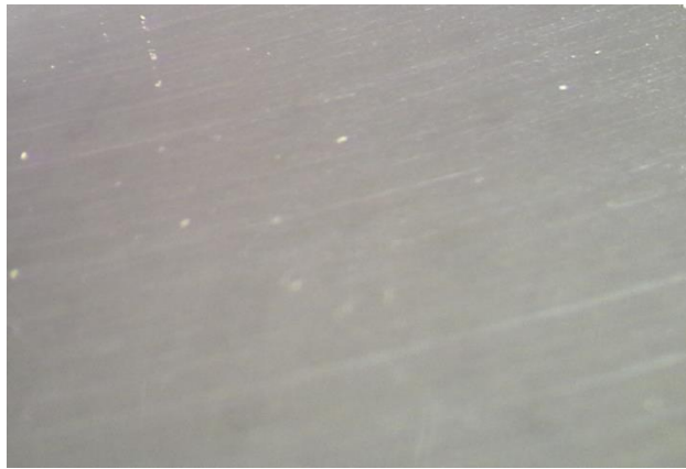
Figure 2.9- Microstructure de l'acier inoxydable 316L en polissage jusqu'à 1200 avec une pate diamanter
