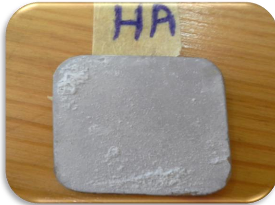
Figure 2.11- Aspect visuel de dépôt de l'hydroxyapatite HA sur l'acier inoxydable 316 L
