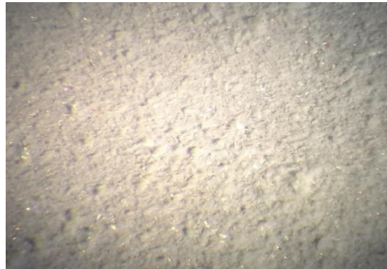
Figure 2.12- Microstructure de dépôt de l'hydroxyapatite HA sur l'acier inoxydable 316L après la calcination
