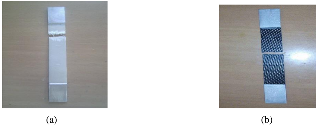
Figure III.4: Zone de rupture de l'éprouvette de traction, (a) : Epreuve verre/époxy après rupture ; (b) : Epreuve carbone/époxy bidirectionnelle après rupture.
