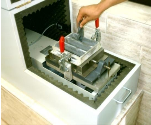
Figure.3.12 : machine d'essai de résistance
