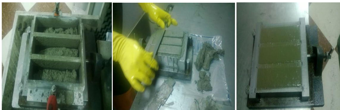
Figure .3.14 : les images des différents étapes pour préparer un moule .
