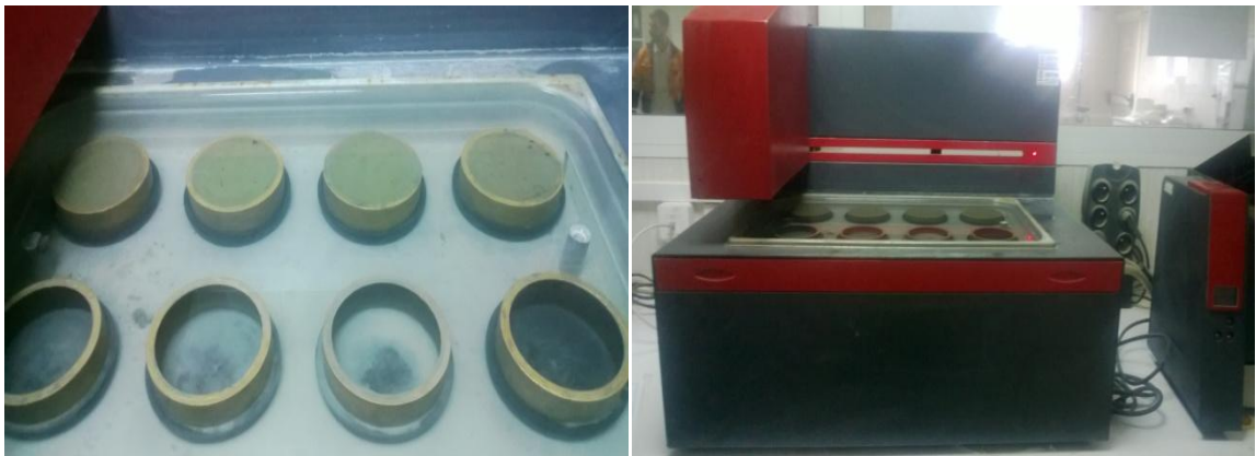
Figure 3.7 : Appareil de Vicat automatique.
