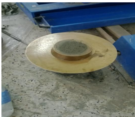
Figure .3.19 : table à secousses.
