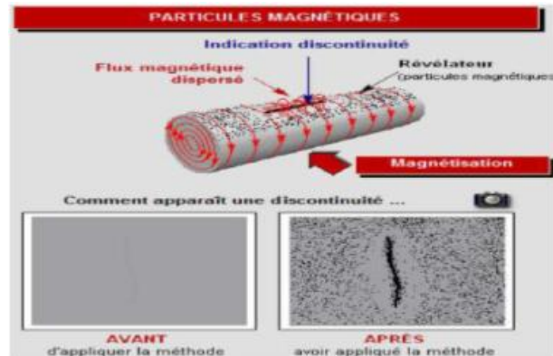
Figure (I.7) : Examen magnétoscopique
