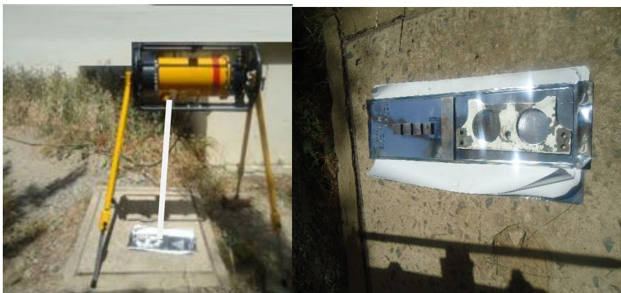
Figure (V.10) : Contrôle radiographique du cross bar
