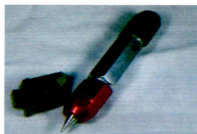
Figure IV.9(a) Scriber, (b) l'utilisation du Scriber sur nos ailettes.
