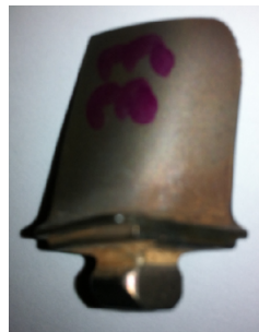
Figure IV.4.c Echantillon découpé de l'aillette du 8 ème étage.
