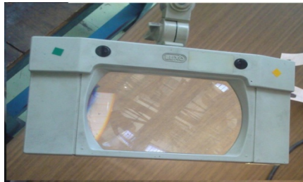
Figure IV.5 : Inspection avec loupe sous lumière blanche.
