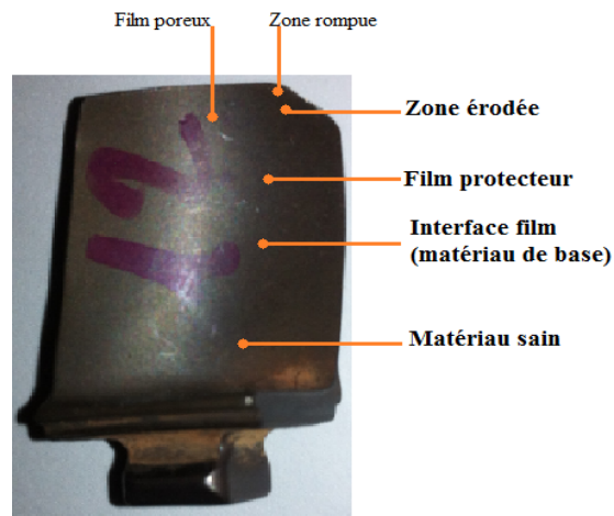
Figure V.1 1- Emplacement des caractérisations micrographiques sur la surface des ailettes étudiées.
